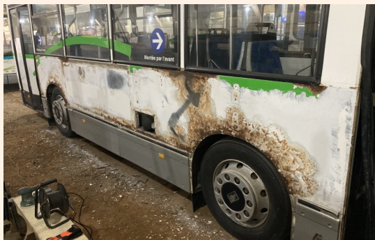
▲ Premier travaux de ponçage sur la carrosserie du GX 77 H n°9153. © Thomas RICHIER / 14.09.2025 ▲
