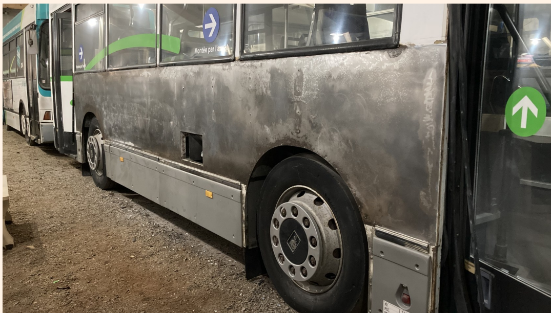
▲ La peinture et la corrosion laissent place à une tôle nue en bon état. © Thomas RICHIER / 15.09.2025
