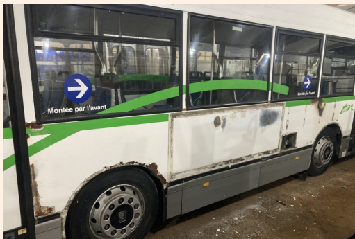
▲ Premier travaux de ponçage sur la carrosserie du GX 77 H n°9153. © Thomas RICHIER / 14.09.2025 ▲
