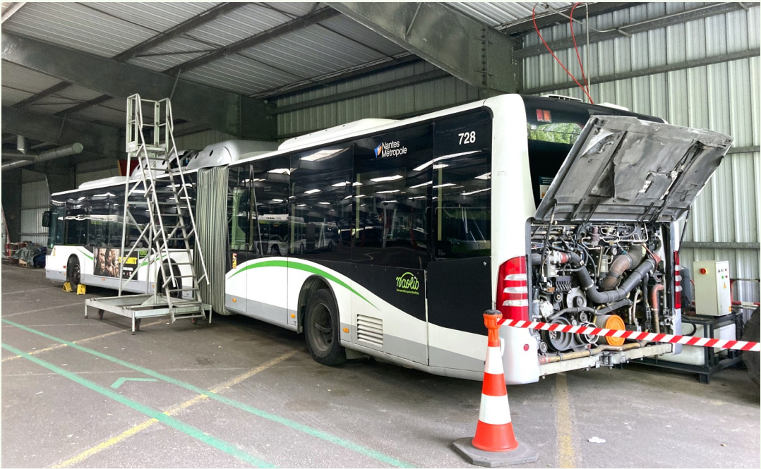
▲ Le bus n°728 est en phase de dépollution avec le vidage des réservoirs de gaz. © Thomas RICHIER / 24.04.2025
