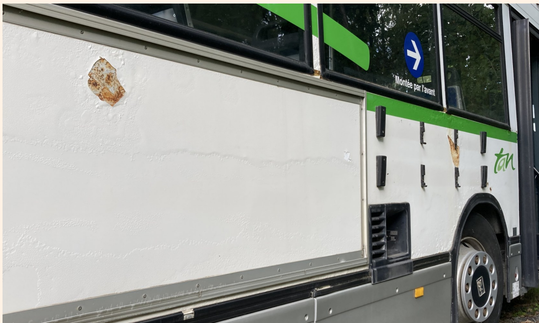
▲ Diagnostic de l'état de la carrosserie avant le démarrage du chantier « test ». © Thomas RICHIER / 09.09.2025
